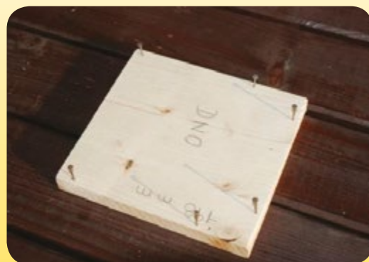
5 Na dno si předchystáme hřebíky. Na třech stranách natlučeme po dvou hřebíky. Dáváme pozor, abychom hřebíky nezatloukli skrz.
